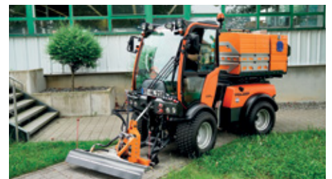
C-Reihe mit Schwemmanlage
