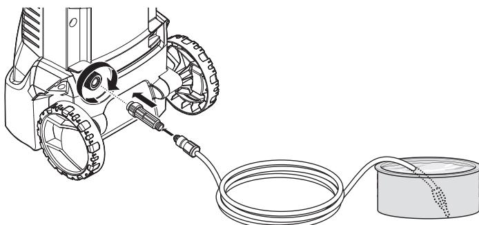
ため水を利用して高圧洗浄機を使用する場合は、まず「呼び水」を行います。呼び水を行うことで本体内部や自吸用ホース内の空気が抜け、高圧洗浄機に負担をかけずに使用することができます。
