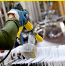
Het gebruik van een schuimlans brengt het reinigingsmiddelenverbruik met circa 50% omlaag.
