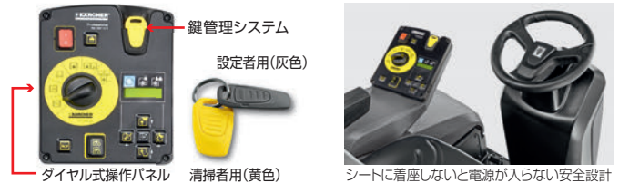
シートに着座しないと電源が入らない安全設計
