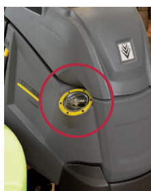
右側の給水口
