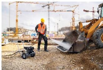
建築業界で使用される清掃機器で一般的な15MPaよりも出力の高い20MPaを実現。またパワーノズルを使用しているため均一な水流を吐出可能です。
