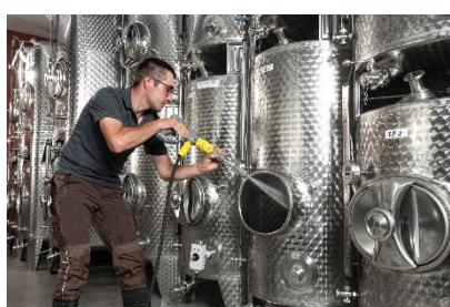
*Molti viticoltori utilizzano serbatoi in acciaio inox per la fase di fermentazione e per lo stoccaggio. Questi serbatoi presentano dei vantaggi per quanto riguarda la pulizia: in particolare, le incrostazioni di vino possono essere rimosse più facilmente da questi serbatoi.*
