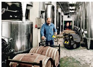
*Il pulitore per botti è un'unità a spruzzo per la pulizia interna di cisterne e botti, in particolare di botti di rovere con capacità compresa tra 225 e 600 litri.*
