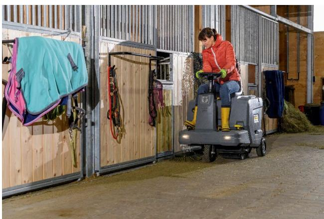
*Le aree di grandi dimensioni, come i corridoi delle stalle, possono essere pulite molto più velocemente e senza sforzi fisici con la spazzatrice uomo a bordo. La macchina dovrebbe essere dotata di una spazzola laterale, che pulisce in modo ottimale anche i bordi delle aree del pavimento.*
