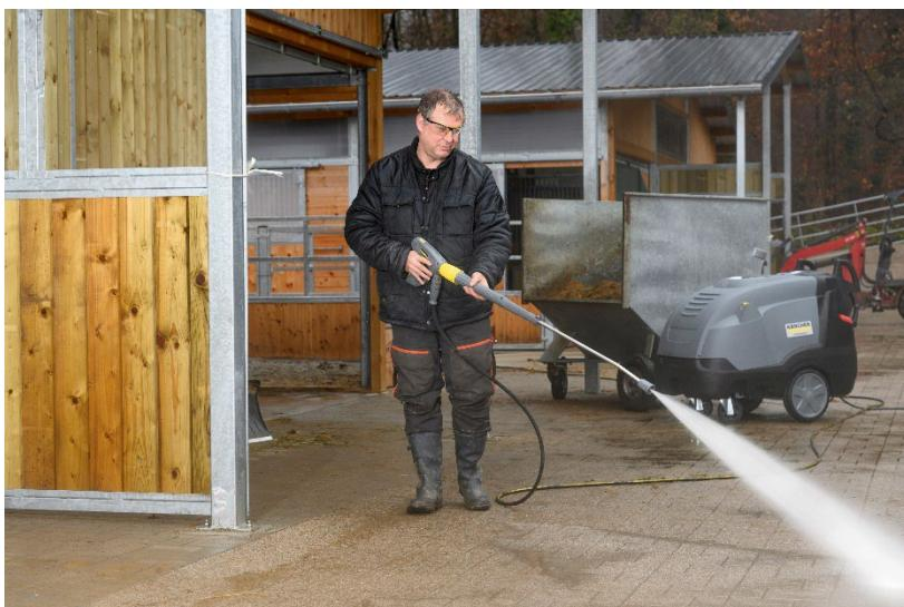
*La pulizia a umido può essere effettuata con un'idropulitrice ad acqua fredda o calda, in modo rapido e senza sforzi fisici. Anche i disinfettanti possono essere facilmente applicati con l'idropulitrice.*
