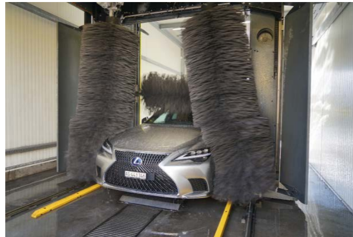
Die Seitenbürste «K!Brush iQ» ist in fünf bis sieben einzelne Segmente unterteilt.
