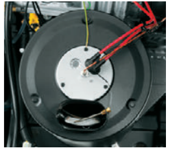
排ガス温度モニター 安全にご使用いただくために、異常温度を検出した場合は機械を停止させる機能を備えています。
