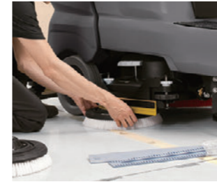
ディスク交換に工具は不要 工具不要でブラシやスクイジーが交換可能
