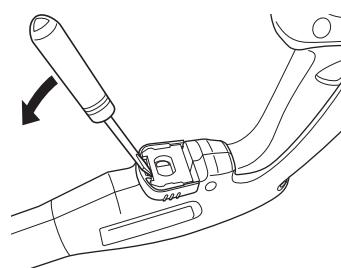
④ トリガーガンの穴の形状に合わせ、高圧ホース先端の平面部分が前後方向になるようにします。
