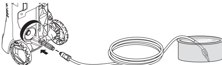
ためた水を利用して高圧洗浄機を使用する場合は、まず「呼び水」（高圧洗浄機とホース内に水を入れる）を行います。呼び水を行うことで本体内部や自吸用ホース内の空気が抜け、高圧洗浄機に負担をかけずに使用することができます。
