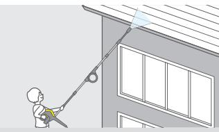
延長パイプを最大に伸ばせば、より高い場所も洗浄できます
