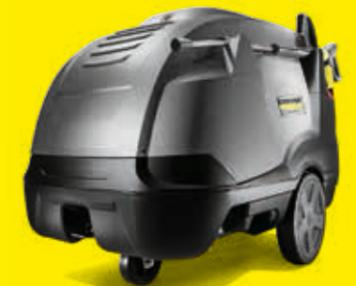
Mit Heißwasser unter Hochdruck werden vergleichbare Reinigungsergebnisse bei deutlich verringertem Wassereinsatz erzielt. Darüber hinaus kommt bei **Heißwasser-Hochdruckreinigern** die ecoefficiency-Stufe zum Einsatz. Ist sie aktiv, wird die Wassertemperatur auf 60°C geregelt, denn diese Temperatur ist für die meisten Reinigungsaufgaben völlig ausreichend.
