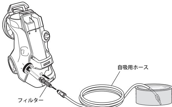
ためた水を利用して高圧洗浄機を使用する場合は、まず「呼び水」（高圧洗浄機とホース内に水を入れる）を行います。呼び水を行うことで本体内部や自吸用ホース内の空気が抜け、高圧洗浄機に負担をかけずに使用することができます。
