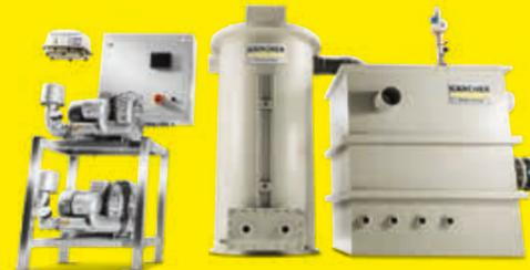
**Система водоочистки WRB 4000 Bio** очищает сточные воды, образующиеся в автомобильных моечных установках, естественным (биологическим) способом. Эта система, пропускная способность которой достигает 4 000 л/ч, позволяет возвращать до 98 % очищенной и не имеющей запаха воды в контур оборотного водоснабжения установки или отводить воду в канализацию с соблюдением законодательных предписаний. При этом чистящие средства и осушители разлагаются в ней без применения флокулянтов или других химикатов.
