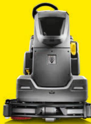
Применение **поломойно-всасывающей машины с сиденьем для оператора B 110 R** значительно облегчает уборку в супермаркетах, аэропортах и складских помещениях и повышает ее эффективность. Машина новой конструкции отличается эргономичностью и высокой производительностью. Ее особенностью является адаптация расхода воды к скорости движения, обеспечивающая значительную экономию воды. При этом она имеет низкий уровень шума и рассчитана на долгий срок службы.
