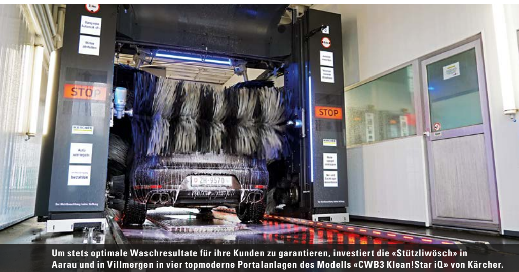
Dank der flexiblen Segmente passen sich die Bürsten der Portalanlage perfekt der Carrosserie des zu reinigenden Fahrzeugs an und sorgen so für ein optimales Waschresultat. Fotos: AGVS-Medien
