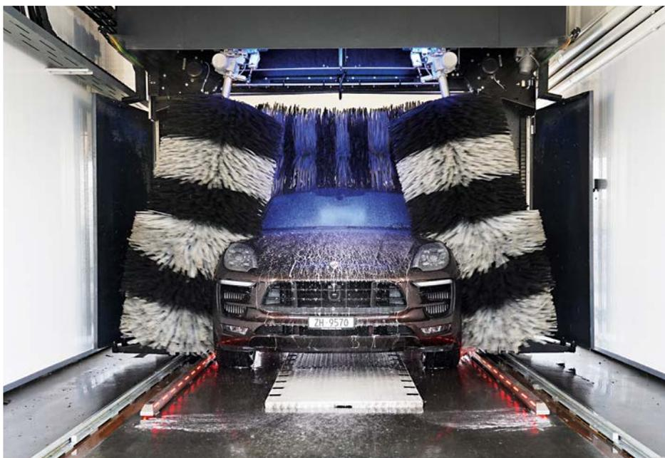
Grâce aux segments flexibles, les brosses du portique s'adaptent parfaitement à la carrosserie du véhicule à nettoyer et garantissent ainsi un résultat de lavage optimal. Photo : médias de l'UPSA
