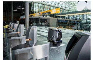
清水補給と汚水排水、タンク清掃、充電を自動で行い、無人のまま補充をして、次の洗浄に自動で清掃します。従来人手が必要だった作業も自動で行うため、より効率的な清掃を可能にします。
