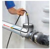
屋外の配管洗浄に便利です(内径 40~200mm)。先端のノズルから高圧水が逆噴射しながら配管に沿って進み、詰まりを解消します。
