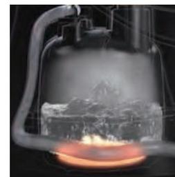
フローヒーター式は、本体内の小さなヒーターを加熱し、その中に水を通してスチームにします。コーヒーマーカのお湯をつくる仕組みと似ています。少量の水をこまめに加熱するので、待ち時間が短く途中で給水できるのが特長です。
