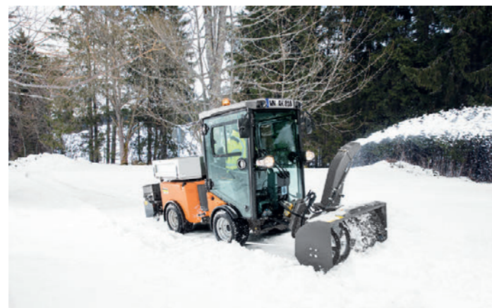
除雪作業：わずかな時間でスーパアタッチメントから除雪アタッチメントへの交換が可能です。
