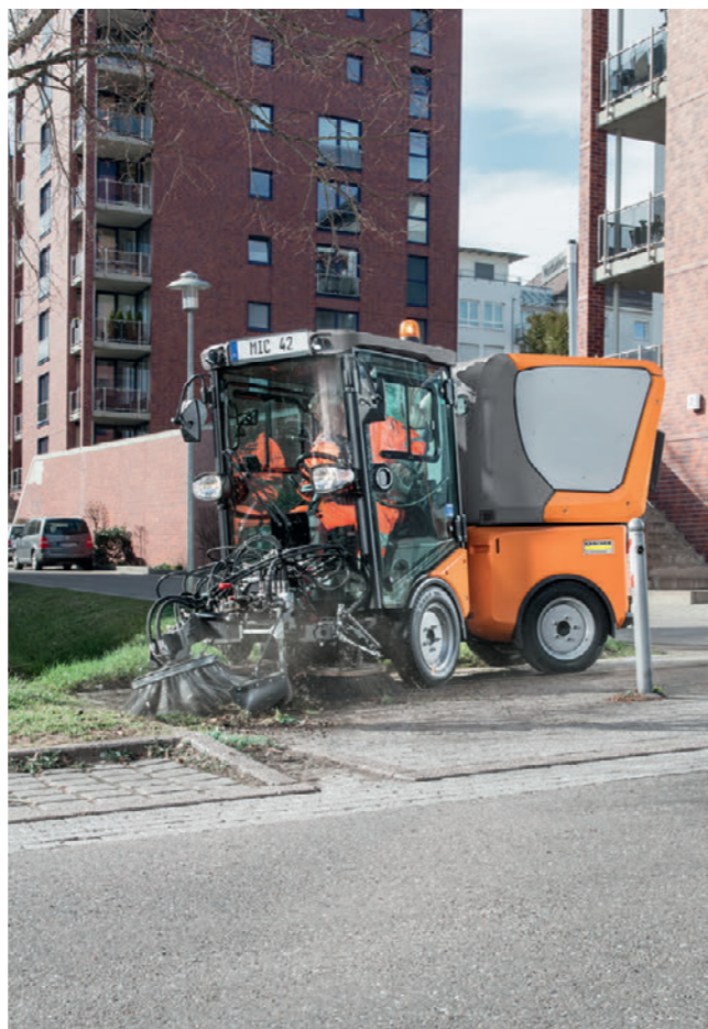
敷地内の草刈り作業：オプションの草刈りブラシを使用することで、コンクリートの隙間に生えた雑草も短時間で効率よく清掃可能です。
