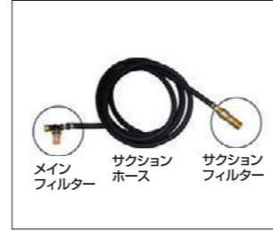
自吸用ホース(サクショホース) ため水を利用する際に使用するホースです。必ずメインフィルター(本体側)と、サクショフィルター(ため水側)の2種類を使用してください。
