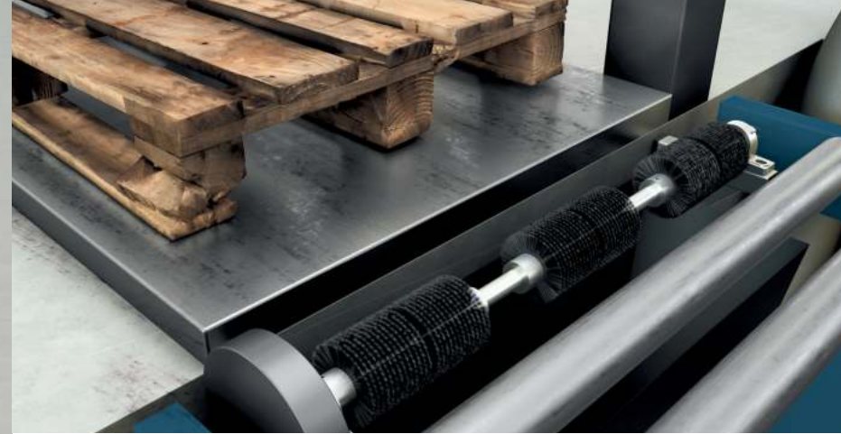
Dabei fährt die Palette über Bürsten, die den Schmutz abnehmen, der automatisch abgesaugt wird.
