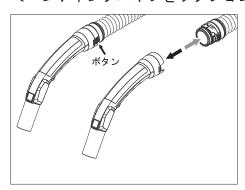
ベンディングパイプをサクションホースから取り外す場合はベンディングパイプの穴にはまっている2つの突起を押し込みながらベンディングパイプとサクションホースを引き離して取り外します。
