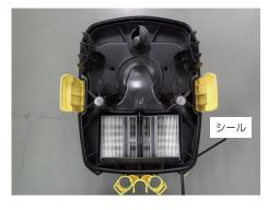
モーターヘッドを取り外しモーターヘッド裏側のシールの 状態を確認します。
