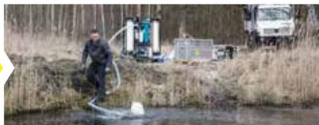
Mit den drei Anlagen von Kärcher Futuretech ist der Trinkwasser-Unimog in der Lage innerhalb eines Tages bis zu 360000 Liter aus Seen, Brunnen und Flüssen zu sauberem Trinkwasser aufzubereiten.
