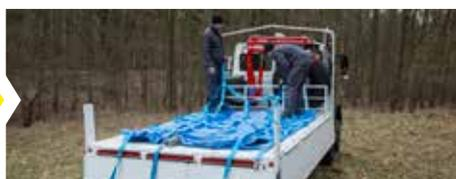
Zur weiteren Verteilung kann das Trinkwasser mithilfe einer fest verbauten und hydraulisch angetriebenen Wasserpumpe in nur 15 Minuten in einen 5000 Liter Kistentank auf der Pritsche des Unimogs umgepumpt werden.
