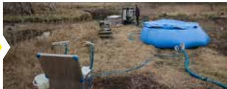
El sistema de purificación de agua WTC 5000 UF con su equipamiento, p. ej., generador y depósito de agua potable, puede ser transportado y montado por solo dos personas.
