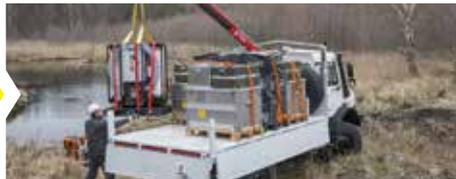
El Unimog de Mercedes-Benz puede transportar hasta tres sistemas de tratamiento de agua completos en su plataforma, los cuales se pueden descargar en el lugar de la intervención con la ayuda de la grúa integrada en el camión.
