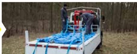
Para la distribución posterior, el agua potable se puede distribuir a un tanque flexible tipo almohada de 5000 litros, situado en la plataforma del Unimog. Unimog, en solo 15 minutos, usando la bomba de agua instalada de manera fija y dotada de accionamiento hidráulico.
