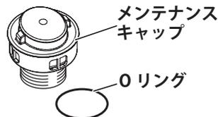
交換時期に到達していなくても、損傷がある場合は新品に交換してください。
