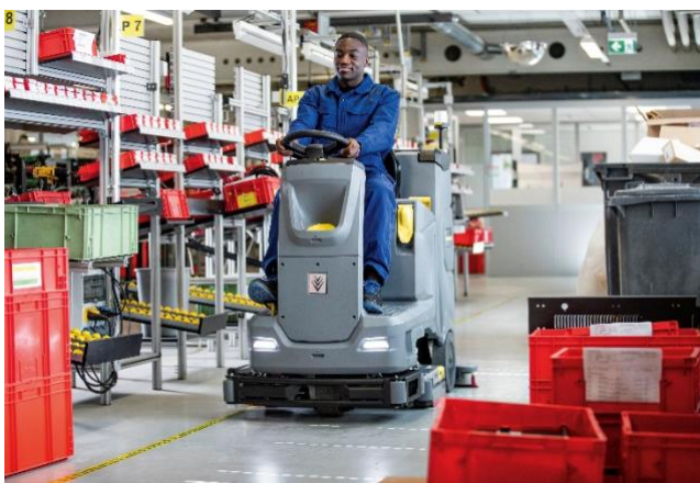
走行速度に応じて吐水量調整、洗剤濃度自動調整機能と汚水タンク自動洗浄機能を搭載 （床洗浄機 B 110 R BP + R75 + DOSE + RINS）
