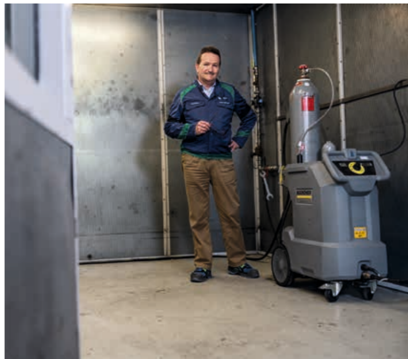
Сухой лед вырабатывается самим аппаратом L2P из CO 2 непосредственно в процессе чистки.
