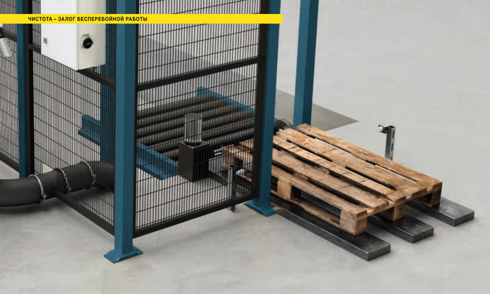
Поступающие на склад поддоны проходят через очистную установку.
