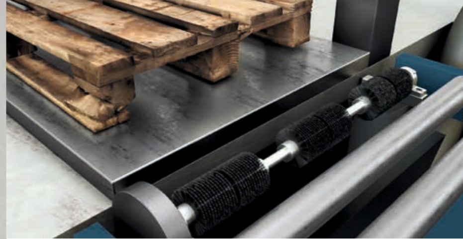
Поддон перемещается над щетками, очищающими его от загрязнений, которые немедленно собираются пылесосом.
