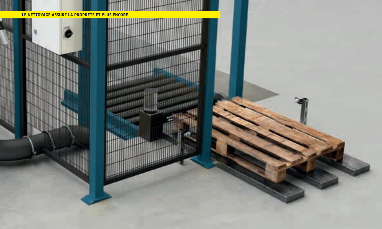
La palette est acheminée vers l'entrepôt via un dispositif d'alimentation.
