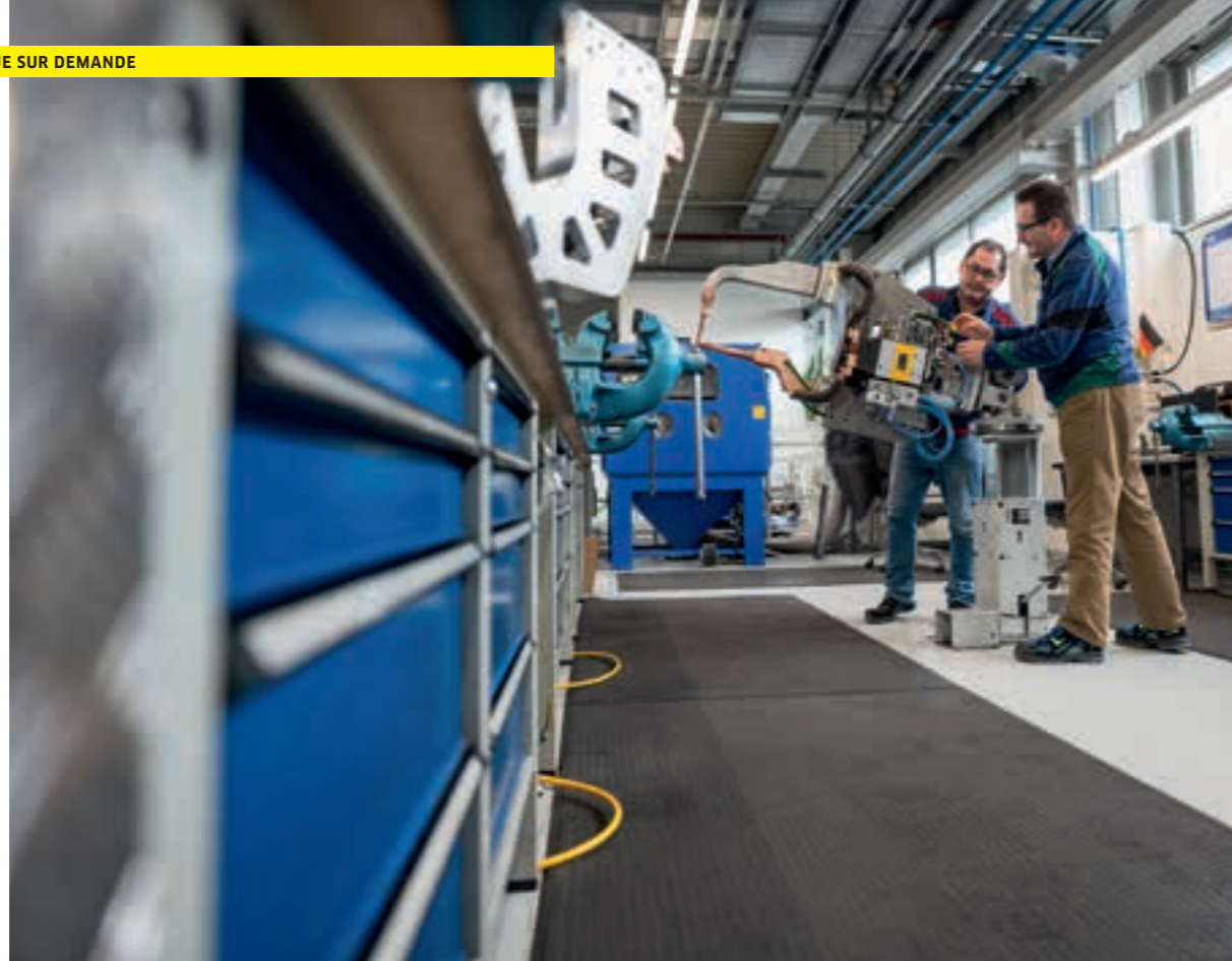
Lorsque les pinces à souder par points arrivent en maintenance, elles sont d'abord contrôlées.
