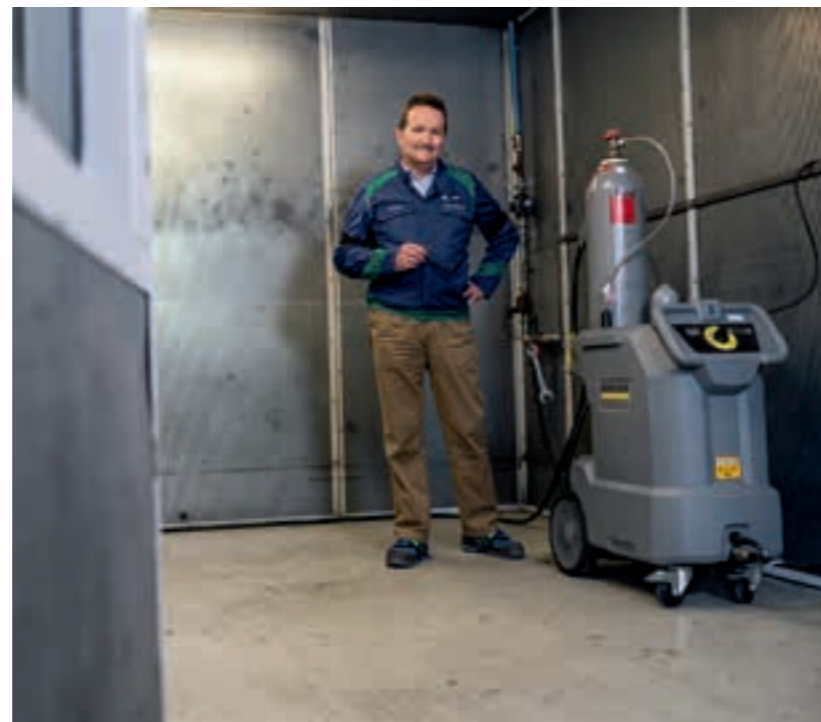
La neige carbonique est générée par l'appareil L2P lors du nettoyage à partir de CO 2 . Cet aspect a convaincu Alfred Weber et son équipe.
