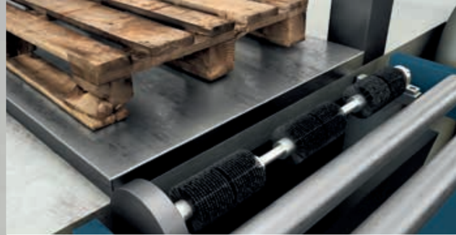
De pallet loopt over borstels die het vuil verwijderen dat automatisch wordt opgezogen.
