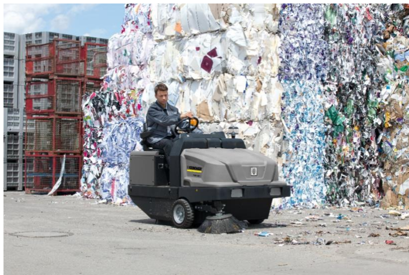
地球環境に配慮したバッテリー式インダストリアルスイーパー（KM 105/180 R Bp Classic）
