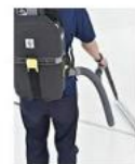
【写真4】ダスターで集めたごみを瞬時に吸塵することができ、衛生的に清掃できる
