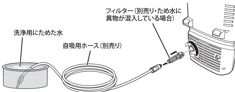
ためた水で高圧洗浄機を使用する場合は、まず「呼び水」(高圧洗浄機とホース内に水を入れる)を行います。呼び水を行うことで本体内部や自吸用ホース内の空気が抜け、高圧洗浄機に負担をかけずに使用することができます。
