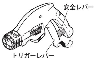
**ロック状態**：安全レバーが起きてトリガーレバーが固定されている
