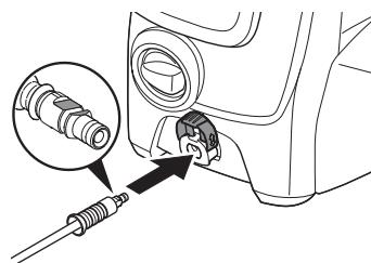
3 留め具をカチッと音がするまで押し込みます。留め具を押し込んだあと、高圧ホースを引っ張って抜けないことを確認します。
