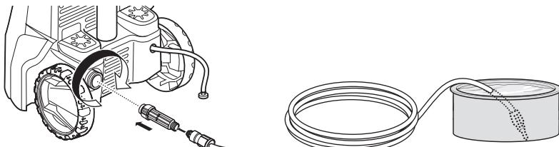
ためた水を利用して高压洗浄機を使用する場合は、まず「呼び水」（高压洗浄機とホース内に水を入れる）を行います。呼び水を行うことで本体内部や自吸用ホース内の空気が抜け、高压洗浄機に負担をかけずに使用することができます。
