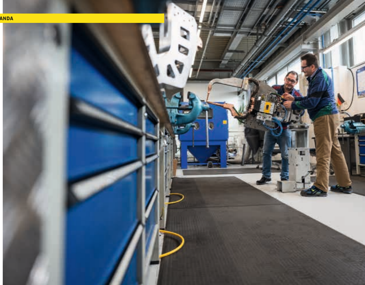
Cuando se efectúa el mantenimiento de las pinzas de soldadura por puntos, primero se comprueban.
