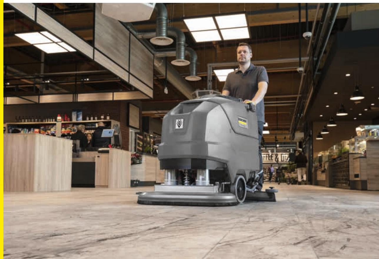
¡A lo grande! Si debe enfrentarse a una suciedad especialmente intensiva, la presión de apriete de los cepillos circulares de nuestra BD 80/100 W Classic Bp se puede adaptar manualmente de 40 a 68 kg. Con un ancho útil de 81 centímetros, un depósito con una capacidad de 100 litros y una velocidad de limpieza regulable de forma gradual hasta 5 km/h, nuestra fregadora-aspiradora robusta, aunque de fácil manejo, permite lograr un rendimiento en superficie de hasta 4.050 m<sup>2</sup>/h.
