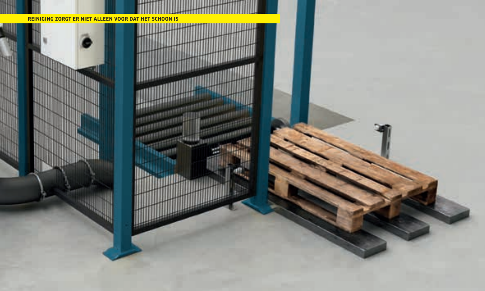
Via een feedersysteem wordt de pallet naar de opslagruimte gevoerd.
