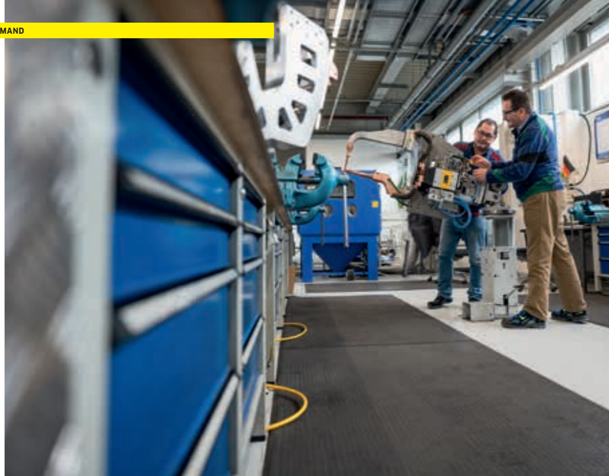
Wanneer de puntlastangen voor onderhoud binnenkomen, worden ze eerst nagekeken.
