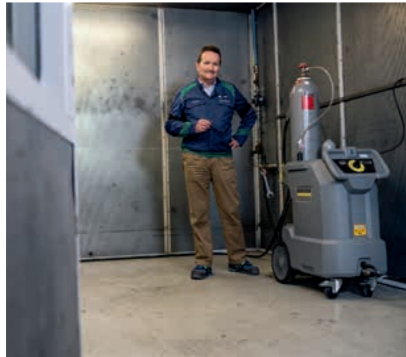
Het droogijs wordt tijdens het reinigen door het L2P-apparaat geproduceerd uit CO 2 . Dat trok Alfred Weber en zijn team over de streep.
