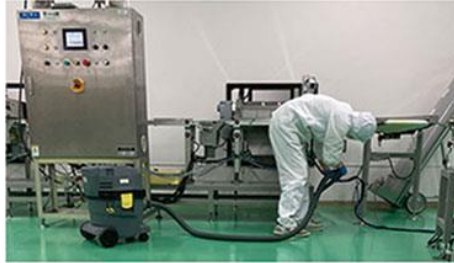
【写真8】 乾湿両用、しかもコードレスであるため、入り組んだ場所でも吸引、吸水が楽に行える
