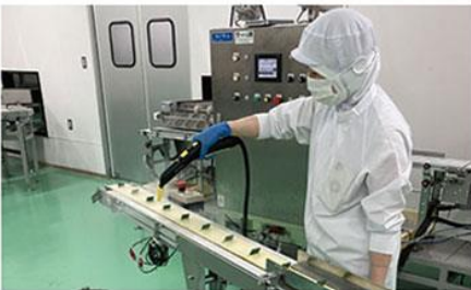
【写真9】 ボイラー加熱温度 145℃、吐出温度約100℃の強力なスチームで、洗剤を使わずに徹底除菌することができる
