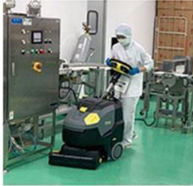
【写真7】 清掃の技能がなくても、力がなくても簡単に床面を洗浄、研磨することができる。ハンドリ式となっていて、旋回、取り回しが楽に
