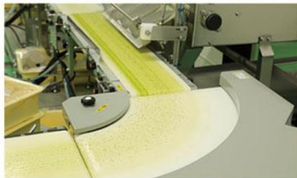
【写真4】コンベヤーにはネギや粉末類が付着しているため、吸引と油污れの除去が必要となる
