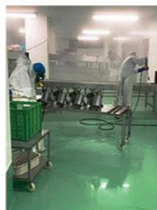
【写真5】常設してあるホースを伸ばすだけで手軽に温水高圧洗浄が可能に
