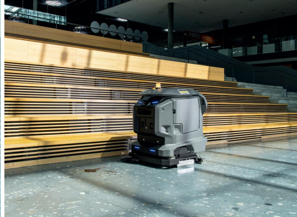
Благодаря мощной литий-ионной батарее емкостью 160 Ач, большой рабочей ширине (55 см) и технологии роликовых щеток, обеспечивающей одновременное подметание, машина KIRA B 50 не уступает в производительности традиционным полomoйно-всасывающим машинам аналогичных размеров.
