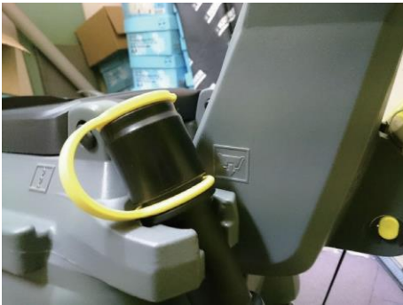
汚水排水ホースのキャップ
