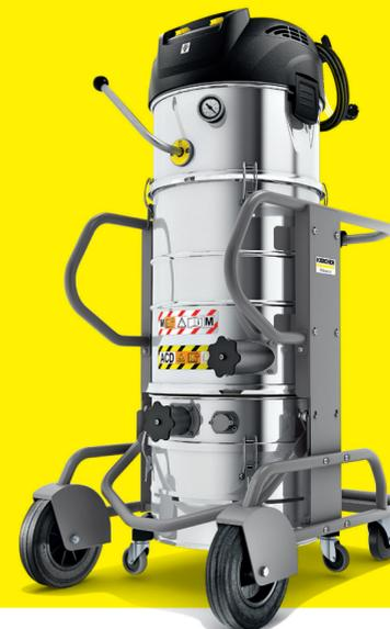
**IVM 60/24-2 M ACD WS** Der Spezialist für die Inertisierung zünd- und explosionsgefährdeter Stäube wie Aluminium, Titan und Magnesium, die beim Schleifen, Polieren oder bei additiven Fertigungsverfahren vorkommen. Der integrierte Nassvorabscheider überzeugt mit rund 530 m<sup>3</sup>/h Luftleistung\* sowie seinen kompakten Maßen. Das Sauggut wird im Flüssigkeitsbad benetzt und die Feststoffe werden im Filtervlies abgeschieden.
