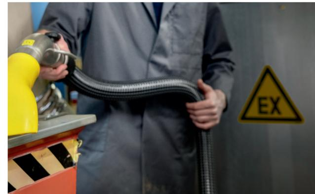
**Bild oben** Gefahrlose Aufnahme brennbarer Stäube – mit leitfähigem Kärcher Zubehör.
