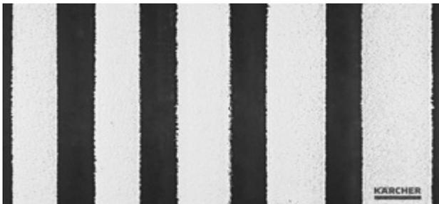
Für den Labortest verwendet das Prüfinstitut eingefärbte Platten, die mit der Rotordüse abgestrahlt werden. Anschließend wird die Effizienz des Reinigungsstrahls anhand der Breite der Reinigungsspur ermittelt. Die Abbildung links zeigt beispielhaft das Ergebnis eines getesteten Kärcher Geräts im Vergleich zu den Ergebnissen der Geräte der Wettbewerber.
