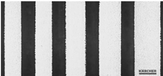
Für den Labortest verwendet das Prüfinstitut eingefärbte Platten, die mit der Rotordüse abgestrahlt werden. Anschließend wird die Effizienz des Reinigungsstrahls anhand der Breite der Reinigungsspur ermittelt. Die Abbildung links zeigt das Ergebnis des getesteten Kärcher-Geräts im Vergleich zu den Ergebnissen der Geräte der Wettbewerber.
