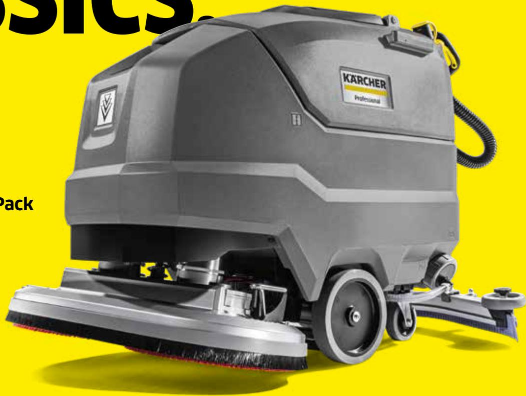
Groß im Geschäft! Warten besonders intensive Verschmutzungen auf Sie, ist der Anpressdruck der Scheibenbürsten unserer BD 80/100 W Classic Bp Pack manuell von 40 auf 68 Kilogramm anpassbar. Mit einer Arbeitsbreite von 81 Zentimetern, 100 Liter Tankvolumen und der stufenlos bis zu 5 km/h einstellbaren Reinigungsgeschwindigkeit ermöglicht unsere robuste und dennoch leicht manövrierbare Scheuersaugmaschine eine Flächenleistung von bis zu 4050 m<sup>2</sup>/h.
