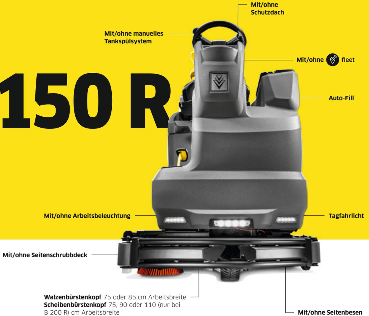
Das beste Reinigungsergebnis bei maximalem Komfort: Mit den beiden Aufsitz-Scheuersaugmaschinen B 150 R und B 200 R können Flächen jeder Art und jeder Größe im Handumdrehen gereinigt werden.
