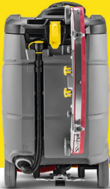
Der gebogene Saugbalken ist in den Breiten 95 und 118 Zentimeter erhältlich. Von Kärcher neu entwickelt und erprobt. Überzeugt auf unebenen Böden und in 180°-Wendungen mit gewohnt hoher Saugkraft.
