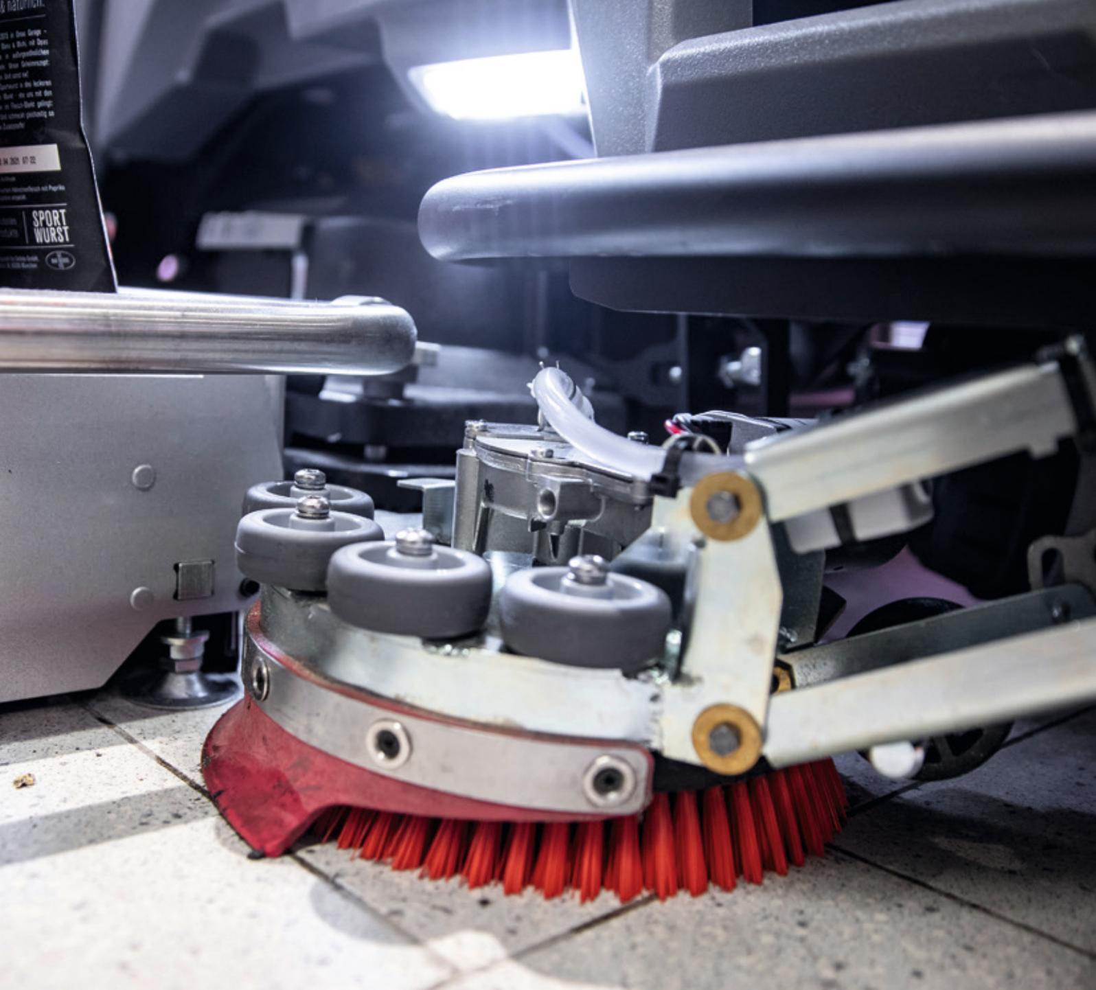
Eine Scheuersaugmaschine mit Scheibenbürstenkopf wird bei leichteren Verschmutzungen und auf glatten Böden eingesetzt.
