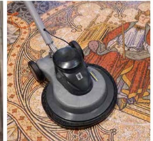
Beim Polieren glatter, hochglänzender Böden erreicht die Ultra-Highspeed-Maschine BDP 50/1500 C eine bis zu 30 Prozent höhere Produktivität als herkömmliche High-speed-Geräte. Die Maschine bewährt sich beim effektiven Polieren von PVC, Linoleum, Parkett und Naturstein. Mit 1.500 U/min legt der leistungsstarke Motor ein hohes Tempo vor. Er sorgt besonders schnell und extrem
