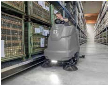
Anschließend mit einer Scheuersaugmaschine 2 bis 4 mal ohne Wasser und ohne Absaugung über den Streifen fahren.
