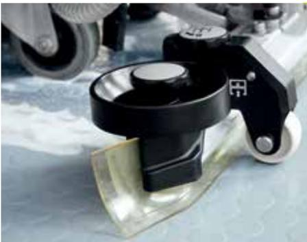
Mit der Scheuersaugmaschine mit viel Wasser (Reinigungsmittelzufuhr abschalten) und mit Absaugung den Streifenbereich großräumig abfahren.
