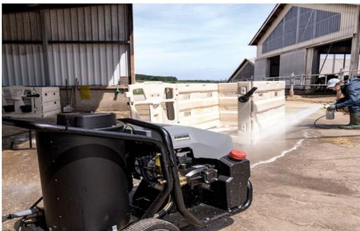
*Les machines sont équipées d'un pistolet à haute pression classique et d'un châssis robuste en acier tubulaire qui permet le chargement par grue.*
