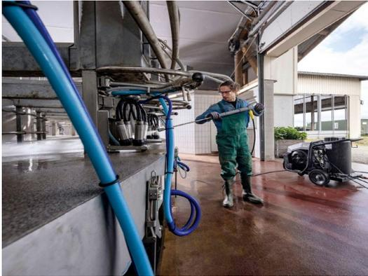
*... et atteignent une pression de pointe de 200 bars et un débit maximal de 1000 l/h.*
