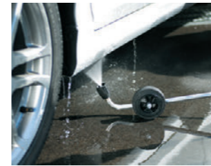
アンダーボディランス 車両をリフトアップしなくても手の届きにくいボディ下部の洗浄が可能です。
