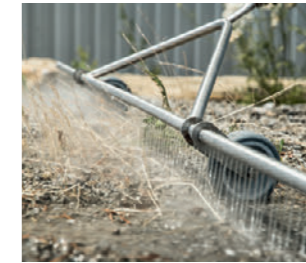
温水除草用ノズル 除草剤を使わないため、環境に優しく経済的です。
