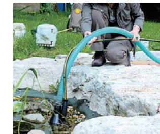
サクションキット 3.6m 水中ポンプを用意せずに高圧洗浄機と接続することにより作業後の排水処理が行えます。
