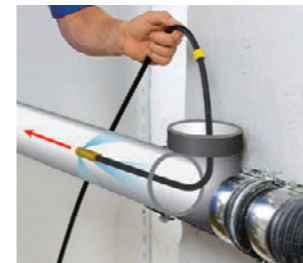
パイプクリーニングホース 内径40mm~200mmの配管洗浄用ホース。先端ノズルの吐出口より高圧水が逆噴射し、配管に沿って洗浄しながら進みます。*曲がり角度90°以内、2ヶ所まで使用可能
