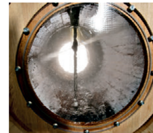
バレルクリーナー バレル1台を5分で洗浄。汚水の回収までこれ1台で対応可能です。
