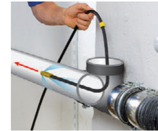
パイプクリーニングホース 内径40mm~200mmの配管洗浄用ホース。先端ノズルの吐出口より高圧水が逆噴射し、配管に沿って洗浄しながら進みます。*曲がり角度90°以内、2ヶ所まで使用可能
