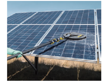
iSolar (太陽電池モジュール洗浄システム) モジュール表面を傷つけずに直接ブラッシングして汚れを除去します。(画像はiSolar 400)
