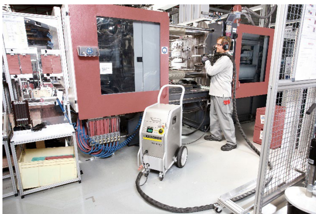
水気を嫌う機器・設備、作業場での使用が可能（ドライアイスブラスター IB 7/40）
