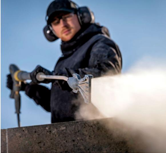
*Sous le signe de la facilité d'utilisation : la nouvelle buse se fixe et se retire rapidement grâce au filetage EASY!Lock.*
